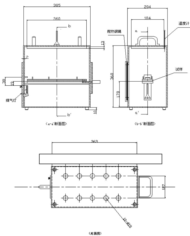
图 2 燃烧箱尺寸示意图
